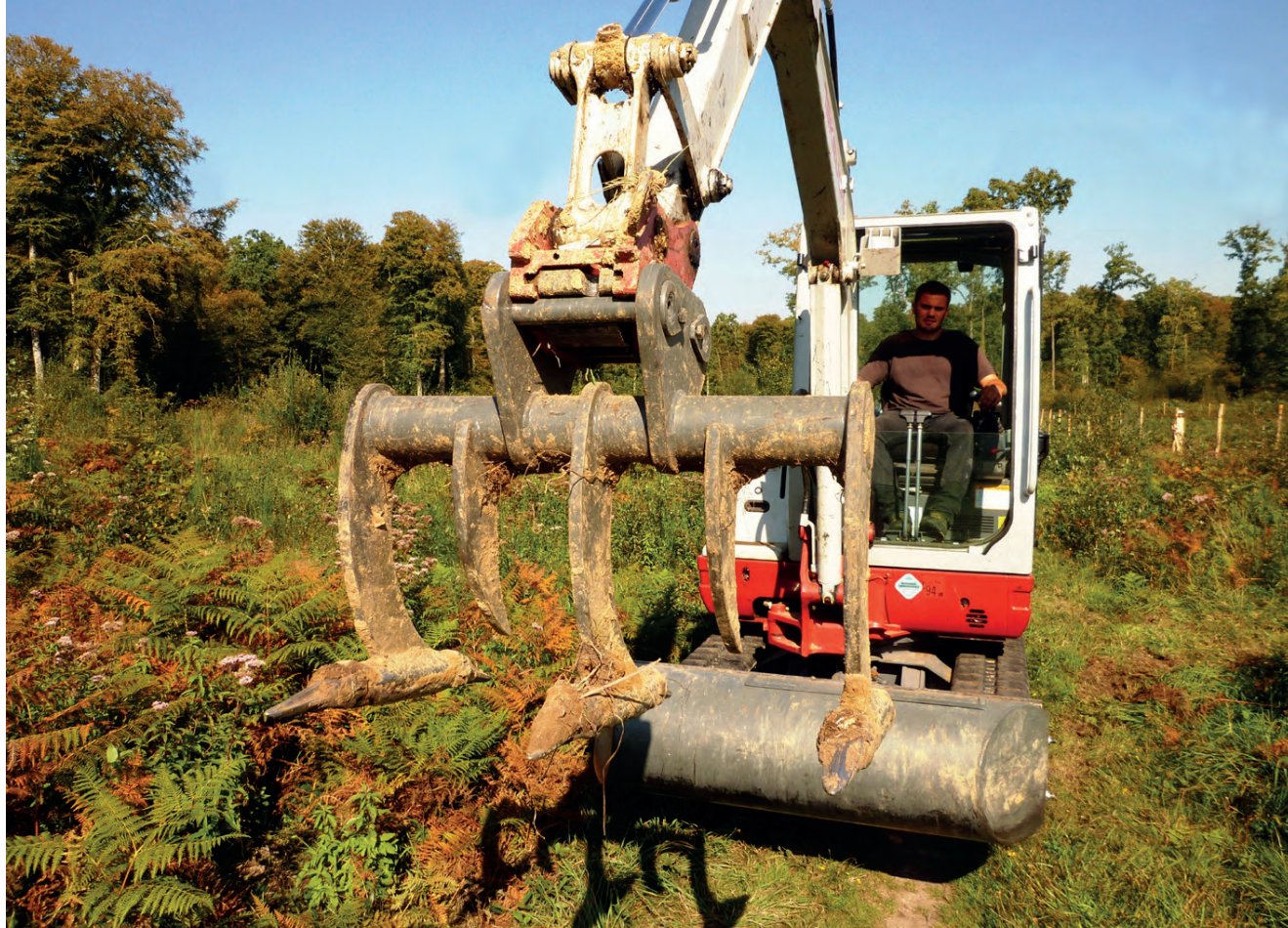
Le Scarificateur réversible® Becker sur minipelle. Léon Wehrlien © Inra
