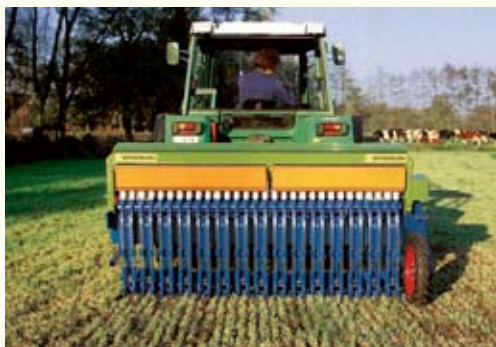
Die Drillsämaschine eignet sich für ebenes Gelände. In feuchtem Boden verstopft und verschmiert sie weniger als die Streifenfräsmaschine.
