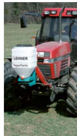
In Kombination mit Striegel und Walze eignen sich Schneckenkornstreuer sehr gut für die Übersaat.
