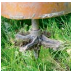
Der Fräskopf der neuen Wuzi-Generation arbeitet sich in die Blacke und zerstört die Wurzel. Prototypen mit diesem Fräskopf sind in Österreich und in Bayern im Praxiseinsatz. In der Schweiz ist der Fräskopf noch nicht getestet worden (Stand Februar 2007).
