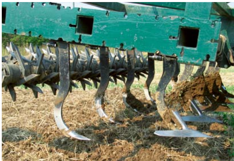
Mit Hilfe des Flügelschargrubbers werden die alten Blackenstöcke möglichst tief unterfahren und anschliessend an die Oberfläche befördert.
